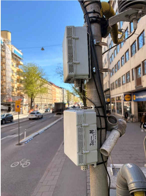
Figur 1. Samplacering av 2st Sensorbee Air Pro 2-enheter på Sveavägen 59 tillsammans med referensutrustning.
