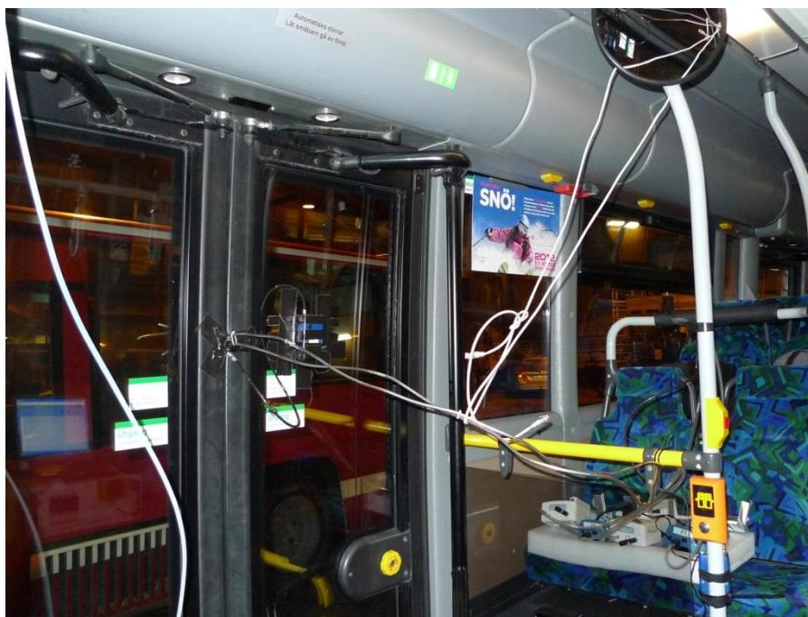
Figur 2. Insug och instrument för mätningar av luftföroreningar inuti och utanför bussen.
