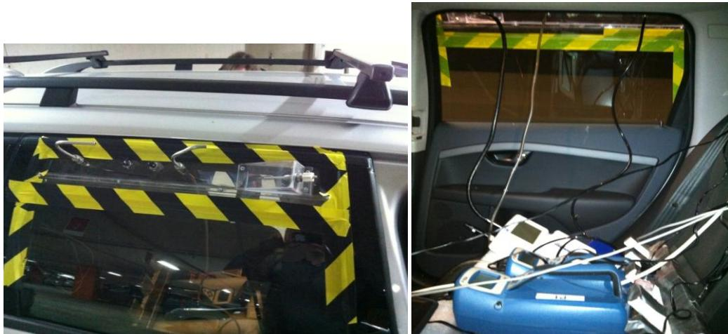
Figur 1. Placering av instrument och insug i Volvo V70.
