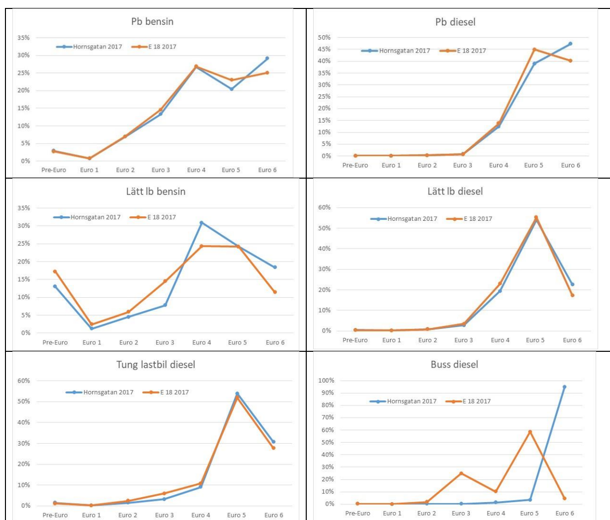
Figur 13. Jämförelse av uppmätt fördelning av euroklasser för olika fordonskategorier på Hornsgatan (blå linje) hösten 2017 med samma typ av mätningar på E18 i Mörby hela år 2017 (orange linje).
